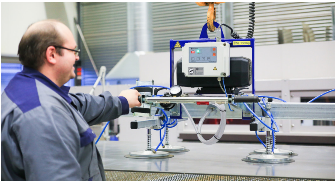
Vakuumheber zur Beschickung der Laseranlage im Einsatz bei der Müller MKR AG in Vordemwald/AG.
